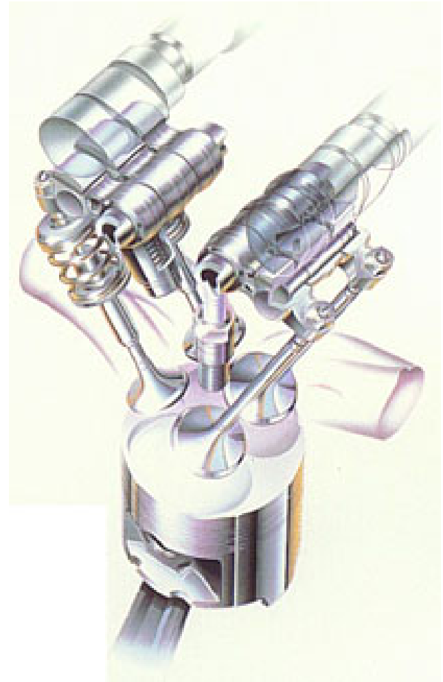
圖六 Honda VTEC引擎的可變氣門裝置
