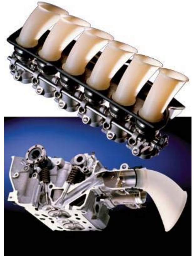
圖一 BMW E46 M3之M-POWER引擎單缸獨立電子節氣門加六喉直噴設計，此乃高轉速高進氣效能保證
